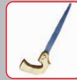
Serrucho de punta: Para despuntes, verticales, longitudinales, y transversales.
