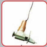
Caladora de baja velocidad: Para cortes longitudinales transversales y especiales, como orificios para paso de tuberías, etc.
